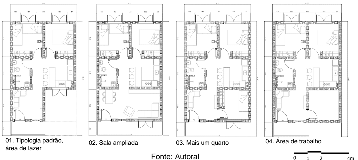
Figura 10 – Tipologias padrões e suas variadas opções de ampliação e uso – 64 m 2 .
