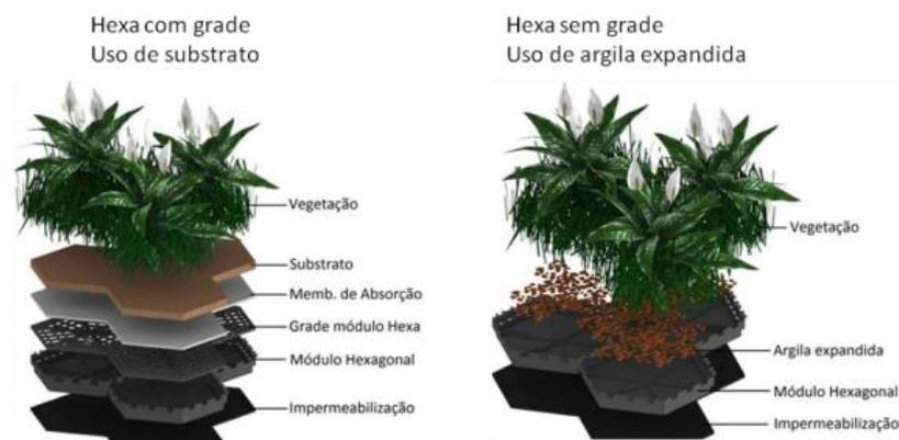
*Imagem esquema 15: Telhado verde Sistema Hexa Ecotelhado. Fonte: <https://ecotelhado.com/wp-content/uploads/2013/09/Manual-e-especificac%CC%A7o%CC%83es-Sistema-Hexa.pdf> . Acesso em: 29 Julho 2016.*
