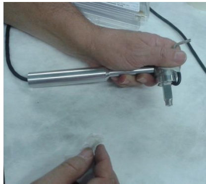
Foto 4 - Montagem e limpeza do martelo de impacto. (O autor, 2016)
