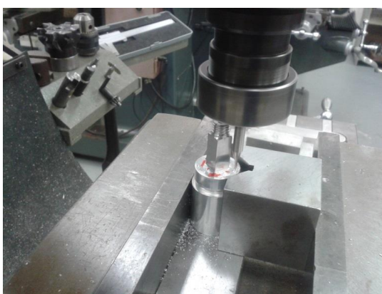
Foto 3 - Usinagem de canais para passagem de fios. (O autor, 2016)
