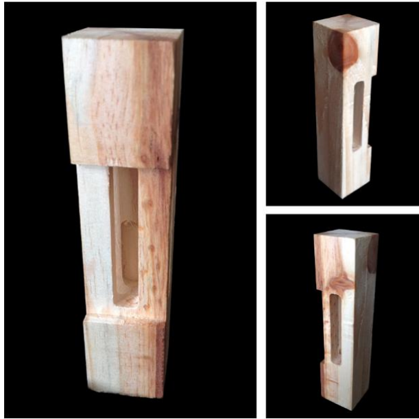
Figura 5 – Peça central (peça 4) apresenta três faces trabalhadas com perfurações ortogonais, a rotação foi possível apenas com o auxílio do quarto eixo opcional.
