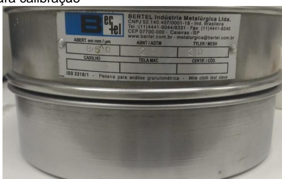
Figura 2: Malha metálica para calibração
