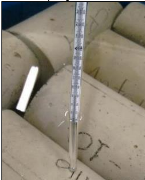
Figura 05: Medição da temperatura da solução agressiva de sulfatos.
