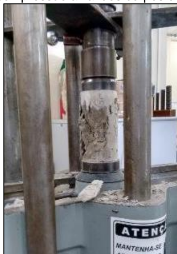
Figura 06: Ensaio de resistência à compressão axial dos corpos de prova de concreto.
