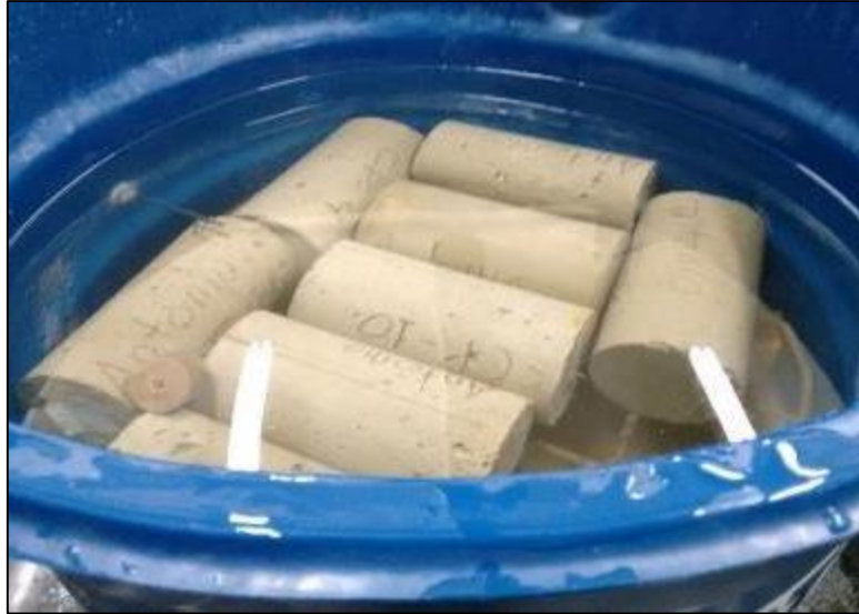
Figura 04: Corpos de prova em solução agressiva de sulfato.
