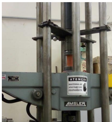
Imagem 6 – Ensaio de Resistência à Compressão Axial
