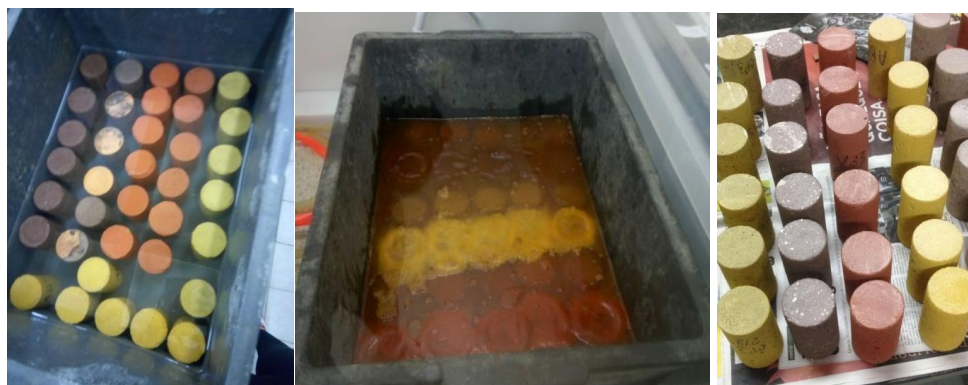
Foto 3, 4 e 5 - Corpos de prova antes, durante e depois do ataque ácido
