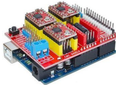
Figura 29: CNC Shield (placa vermelha), com 3 drivers A4988, acoplada ao Arduino.
