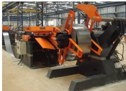
Figura 13 - Parte inicial da fabricação de tubos (Arcel)
