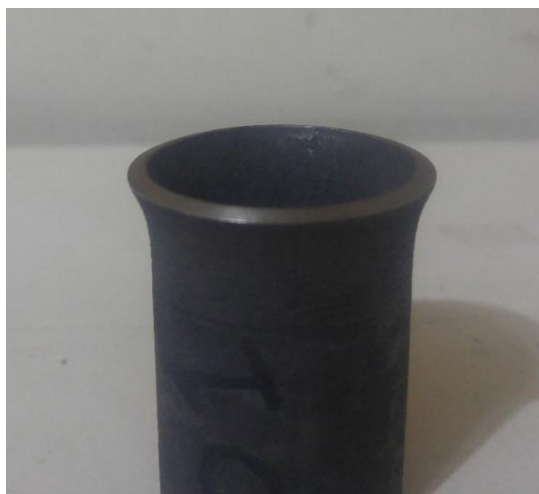
Fotografia 9- Tubo de costura à laser com TT após o teste de expansão cônica.
