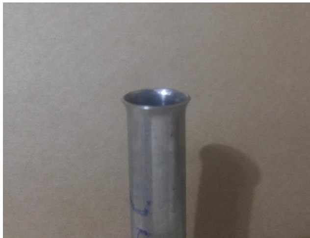
Fotografia 6- Tubo de costura à TIG sem TT após o teste de expansão cônica
