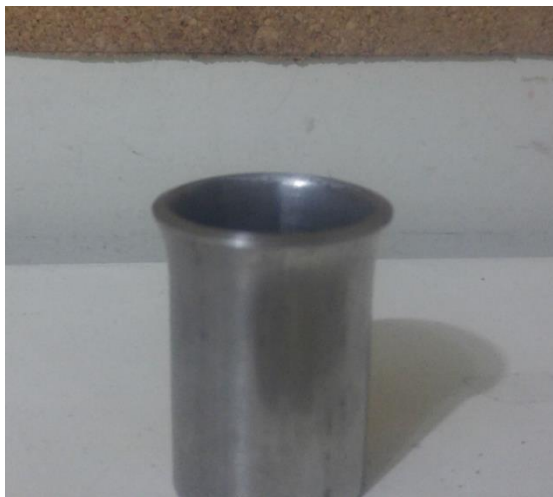
Fotografia 8- Tubo de costura à laser sem TT após o teste de expansão cônica
