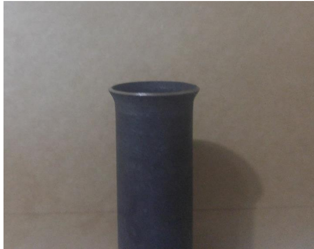
Fotografia 7- Tubo de costura à TIG com TT após o teste de expansão cônica
