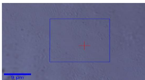
Figura 12. Imagem ótica (100x) da superfície do grafeno sobre o cobre de alta pureza mostrando-se pouco rugosa, porém homogênea.
