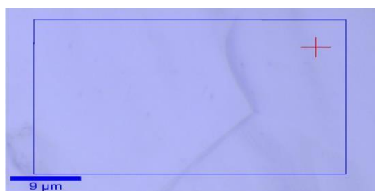
Figura 19. Imagem ótica (100x) da superfície do grafeno obtido utilizando Metano e cobre de alta pureza. Visualmente observa-se uma baixa rugosidade na superfície, com um possível contorno de grão, e sem impurezas aparentes.
