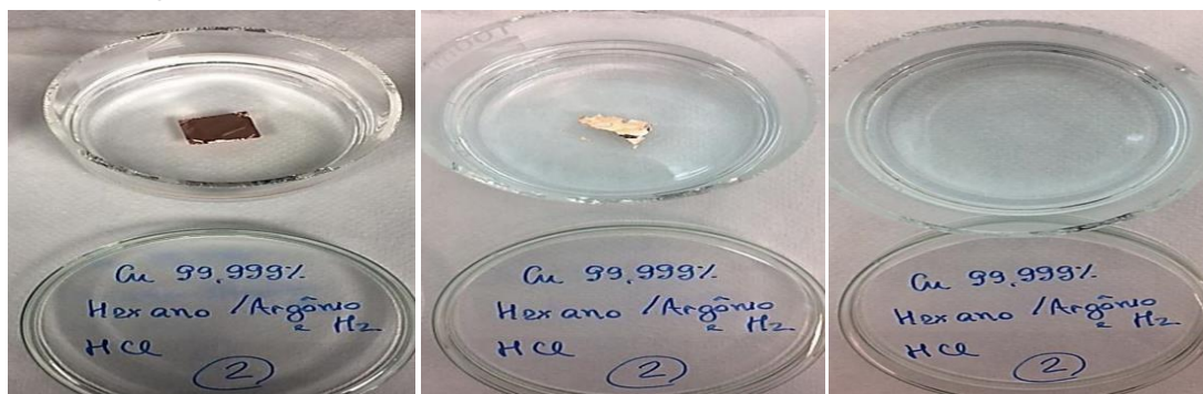
Figura 17. Etapas de transferência –(a) cobre+grafeno antes da corrosão do cobre. (b) cobre+grafeno durante a corrosão com persulfato de amônio (2h30). (c) filme de grafeno antes da transferência para outro substrato, parcialmente transparente, com pequenos fragmentos (5h30).
