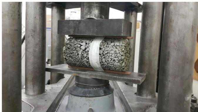
Figura 4.4 – Resistência à tração por compressão diametral
