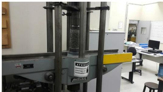
Figura 4.2 – Ensaio Compressão Axial
