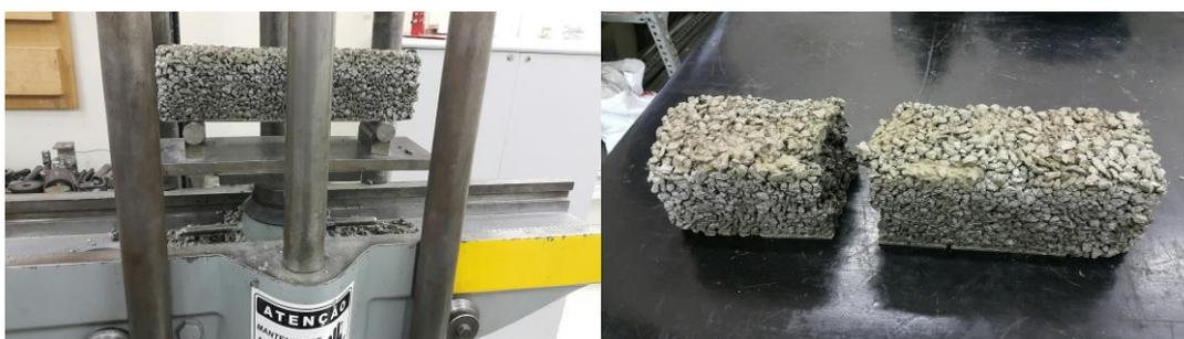
Figura 4.3 – Resistência à tração na flexão
