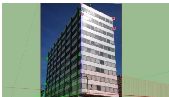
Figura 14 – Ajustes das barras e Localização dos pontos de fuga
