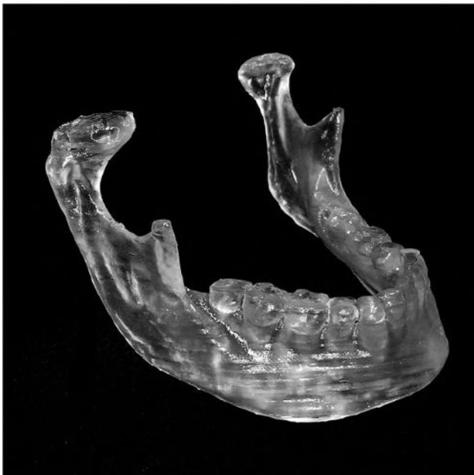
Figura 1: modelo de mandíbula impresso em 3D utilizando técnica de estereolitografia.
