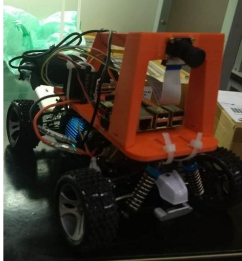
Imagem 8 – Veículo autônomo baseado no Donkey Car, desenvolvido durante o projeto.
