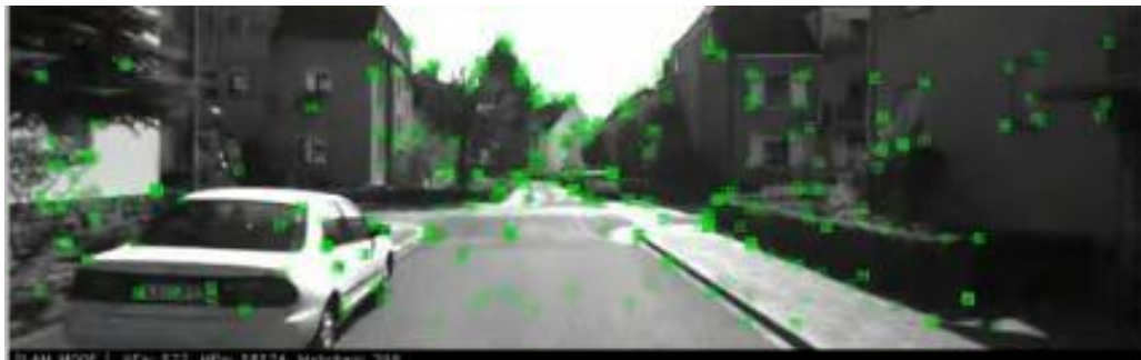
Imagem 7- Câmera RGB-D com ORB-SLAM (Mur-Artal et al ,2016)
