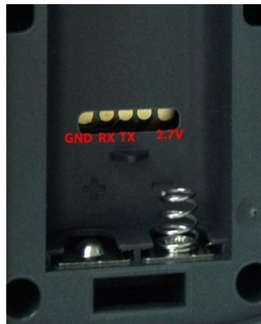
Imagem 1 – Trena laser UNI-T UT390B parte traseira local onde coloca as pilhas, pinos correspondentes descoberto na engenharia reversa, da esquerda para direita GND terra, RX e TX são pinos para comunicação serial entre a trena e o arduino, 2,7v alimentação da trena (FULLER,2016).
