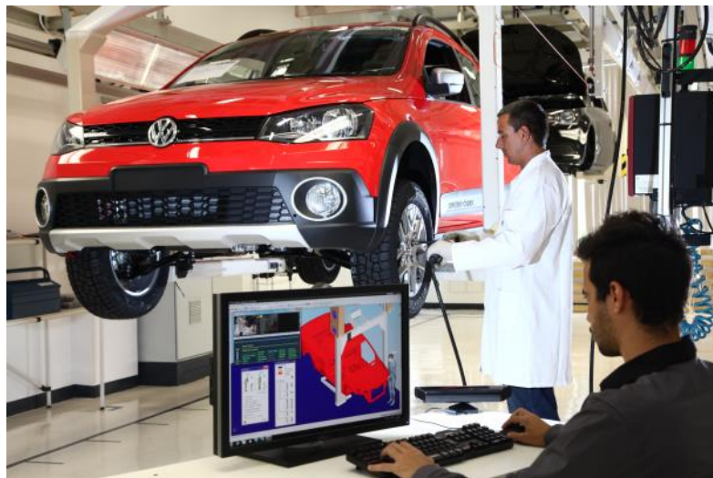
Figura 4: Análise ergonômica nas linhas da Volkswagen feita com simulações virtuais utilizando o Kinect
