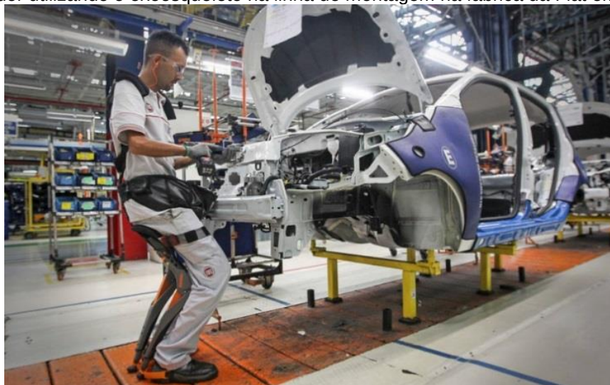
Figura 1: Operador utilizando o exoesqueleto na linha de montagem na fábrica da Fiat em Betim
