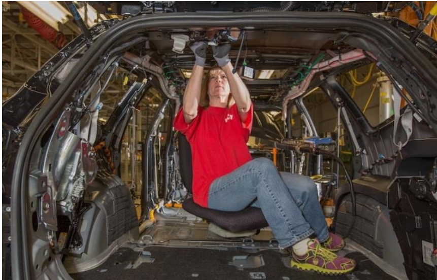
Figura 5: Membro da equipe da General Motors usando a ErgoChair na montagem do Chevrolet Traverse 2014
