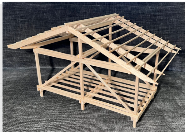
Imagem 8 - Modelo físico do Frame construction (Pilar-viga)
