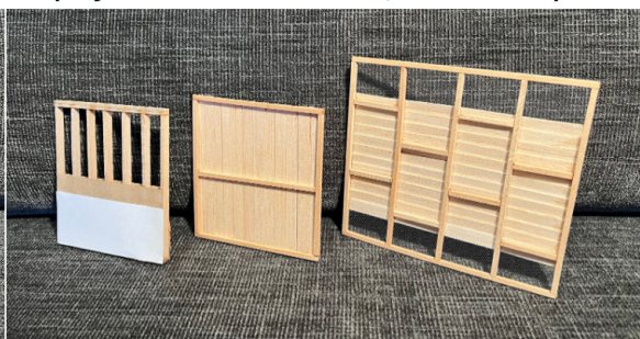
Imagem 10 - Painéis de vedação (face interna) do wood frame, da palafita tradicional e da palafita com adaptações de sustentabilidade, na ordem disposta
