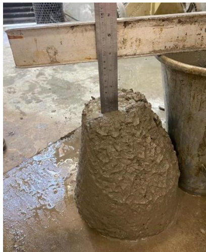
Figura 2 – Ensaio de abatimento do tronco de cone – NBR 16889:2020 (Concreto de Referência - Piloto).
