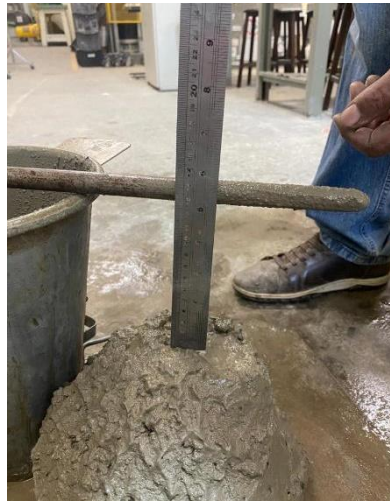
Figura 3 – Ensaio de abatimento do tronco de cone – NBR 16889:2020 (Concreto com 20% de substituição de agregado reciclado).
