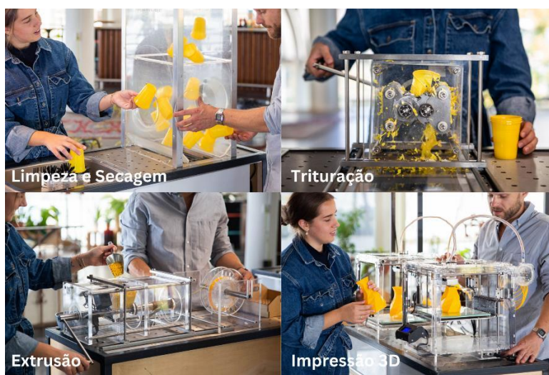
Figura 6 – Processo de impressão 3D a partir de plástico reciclável
