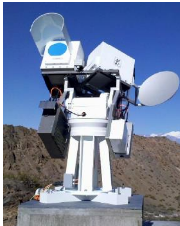
Figura 4: Rádios polarímetros POEMAS a 45 e 90 GHz,
