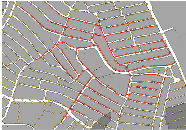
Figura 8 – Mapeamento de cabos na região da Rua Rio Navio usando dados LiDAR
