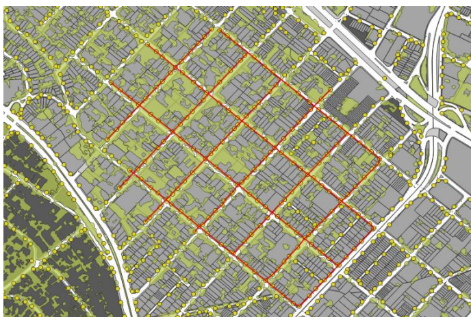
Figura 12 – Mapeamento de cabos na região da Rua Pirandello usando dados LiDAR
