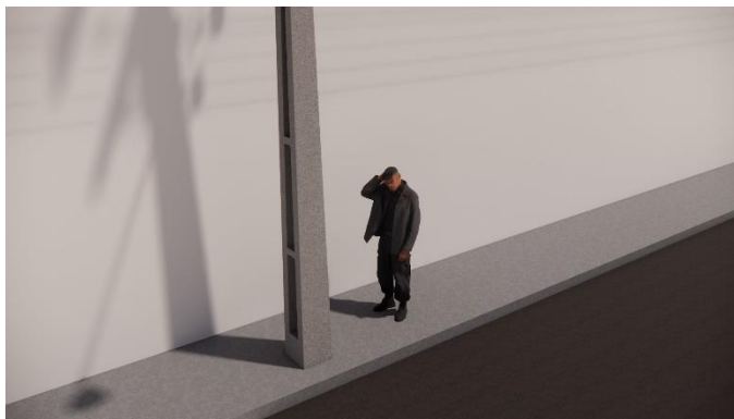
Figura 6 – Esquema virtual ilustrativo da interação problemática dos postes com calçadas de largura menor do que a mínima recomendada
