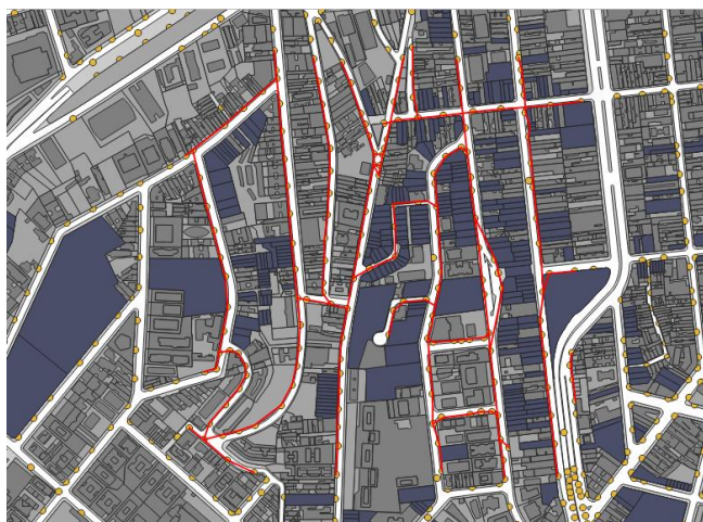
Figura 13 – Mapeamento de cabos na região da Rua Treze de Maio usando dados LiDAR
