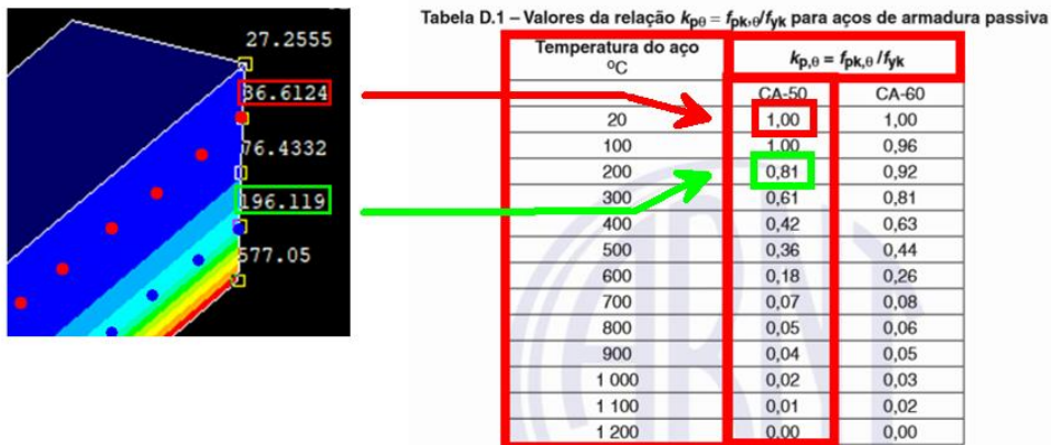
Figura 20 Gradiente de temperaturas comparado com a deformação do aço em função da temperatura.
