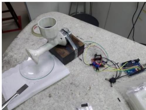
Figura 8 – Sistema completo, com protótipo refeito
