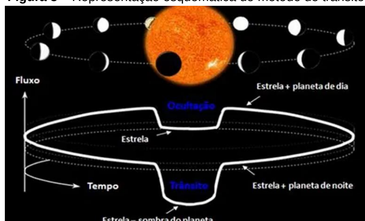
Figura 3 – Representação esquemática do método de trânsito.
