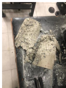
Figura 10 - Resistência à tração por Compressão Axial no Concreto Convencional (7 dias)
