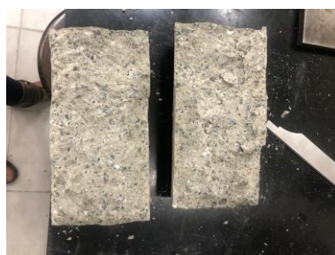
Figura 12 – Resistência à Compressão Diametral - Concreto Convencional com tempo de cura de 7 dias
