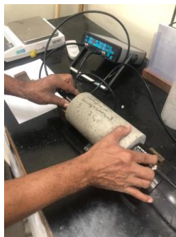
Figura 6 - Propagação de onda – Concreto Convencional com tempo de cura de 7 dias
