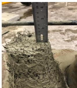
Figura 9 – Corpo de Prova de Concreto Reforçado com Fibra de Polipropileno (CC/PP)
