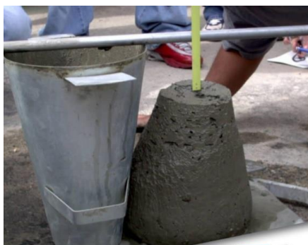
Figura 5 – Slump Test (sasolucoes)
