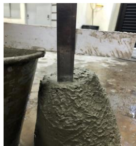
Figura 8 – Corpos de Prova de Concreto Convencional para o Slump teste
