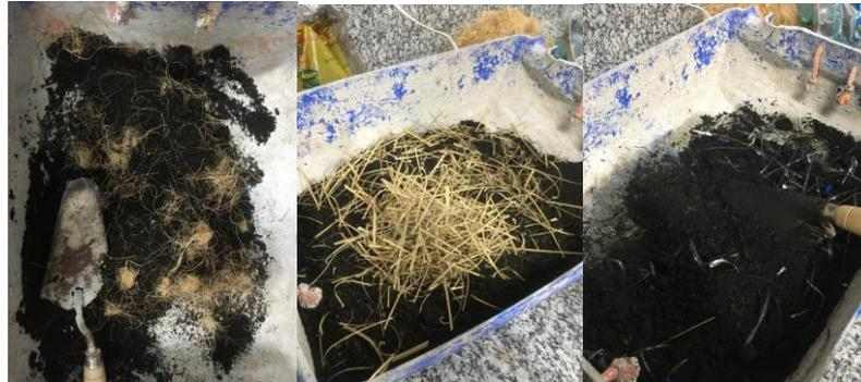
Figura 5 - Terra Inerte misturadas com Fibra de Côco, Bambu e PET. Fonte: autoral
