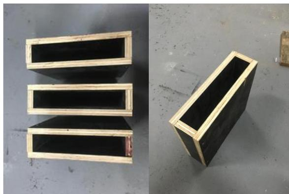
Figura 4 - Moldes de madeira executados no canteiro experimental. Fonte: autoral
