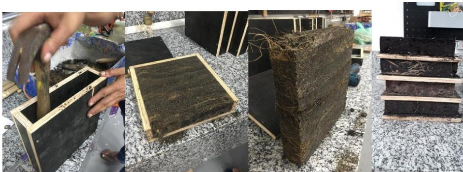
Figura 6 - Processo de desmontagem das formas Fonte: Autoral
