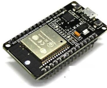
**Figura 5: microcontrolador ESP-32**
