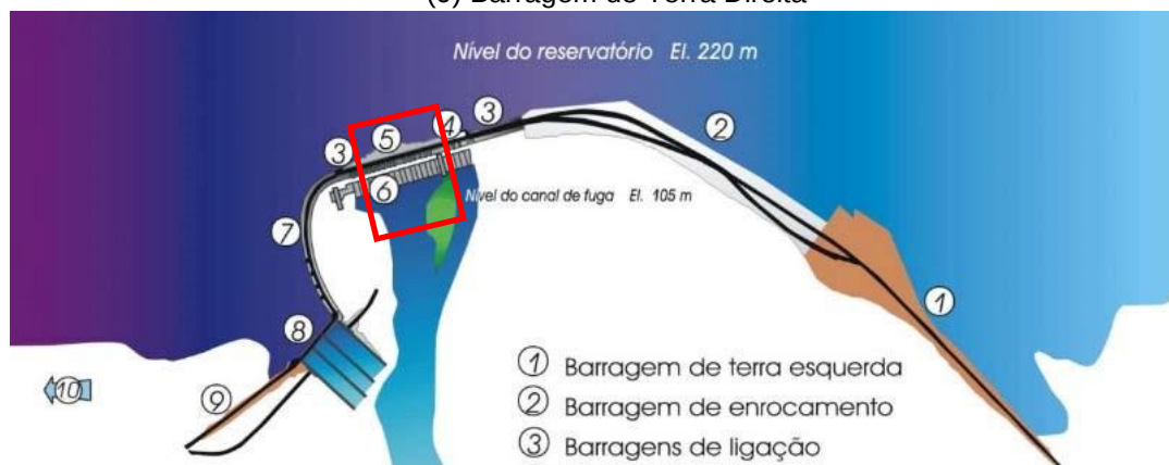
Esquema 1 Barragem Hidrelétrica de Itaipu: (1) Barragem de Terra Esquerda; (2) Barragem de Enrocamento; (3) Barragem de Ligação; (4) Estrutura de Desvio; (5) Barragem Principal; (6) Casa de Força; (7) Barragem Lateral Direita; (8) Vertedouro e (9) Barragem de Terra Direita
