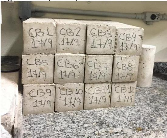
Em seguida foram moldados 12 corpos de prova de concreto pigmentado (Figura 4) para a realização dos mesmos ensaios utilizando a mesma metodologia empregada para o concreto convencional.
