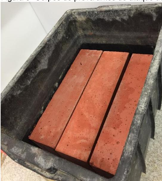
Figura 6-Corpos de prova durante o ataque ácido
