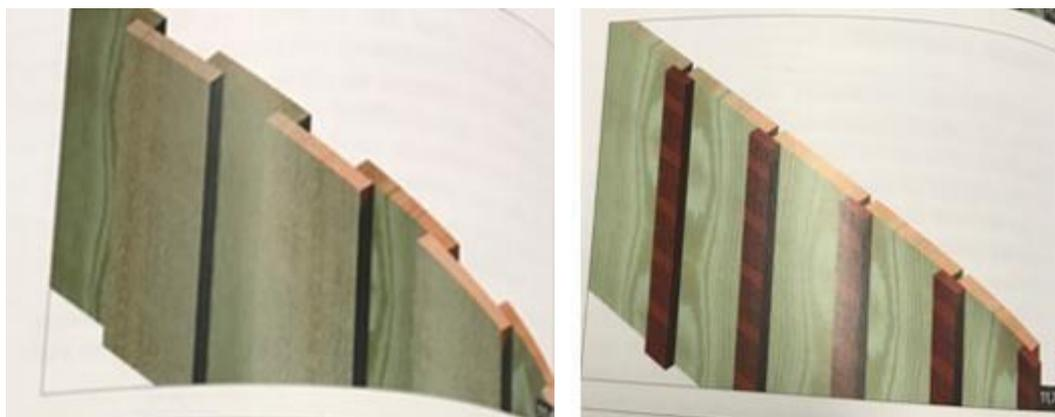
Fig. 1 – Painel de vedação com tábuas posicionadas na vertical.
