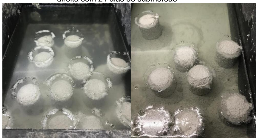
Figura 8 – Comparativo entre sedimentação de resíduos, à esquerda com 4 dias de submersão e à direita com 24 dias de submersão
