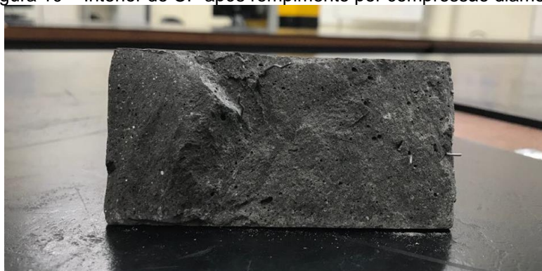
Figura 10 – Interior do CP após rompimento por compressão diametral
