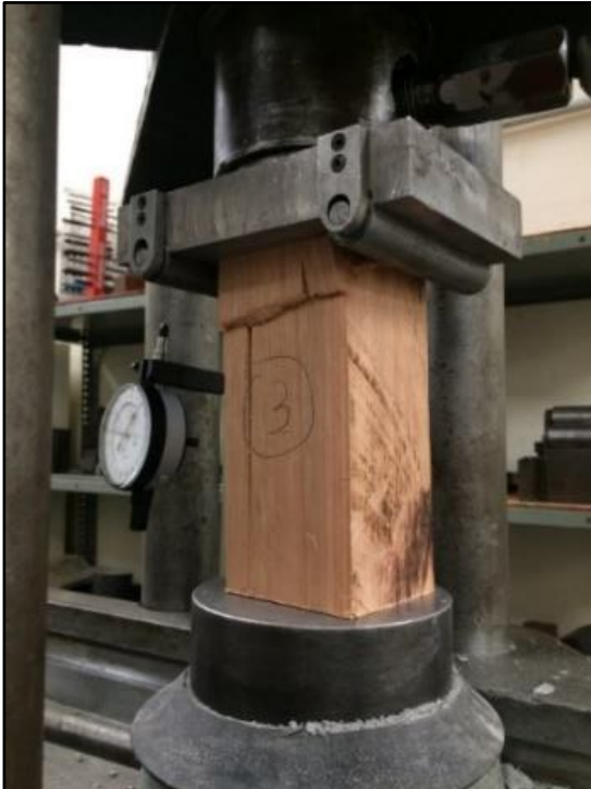
Fotografia 4 – Corpo de Prova de Eucalipto após ruptura a compressão.
