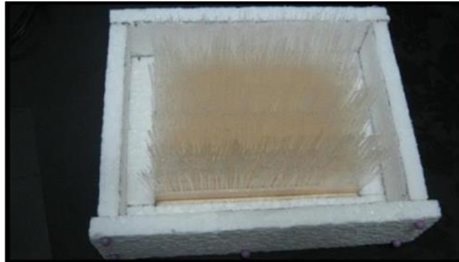
Figura 9: Conjunto de formas de isopor com conjuntos de fibras ópticas, preparadas para a adição de argamassa.
