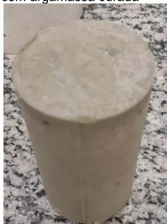
Figura 12: Corpo de prova cilíndrico com argamassa curada
