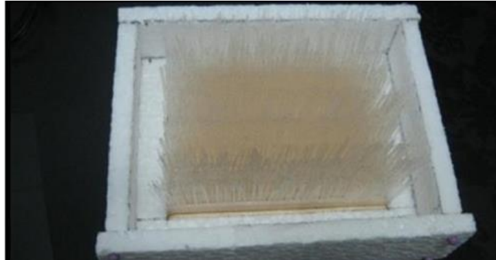
Figura 7: Fibra óptica nas guias de madeira.
