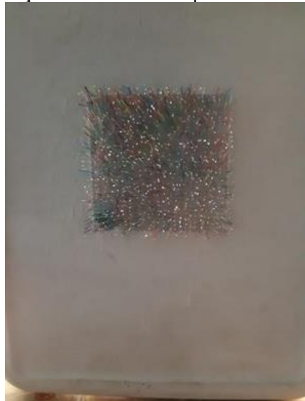
Figura 16: Corpo de prova com adição de 3% de fibra óptica iluminado pela lâmpada
