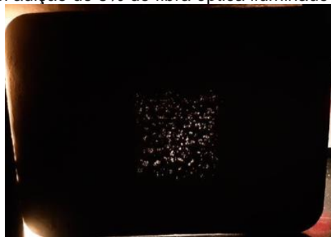
Figura 17: Corpo de prova com adição de 5% de fibra óptica iluminado pela lâmpada
