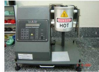
Fotografia 7 – Plastômetro Tinius Olsen MP993a.
