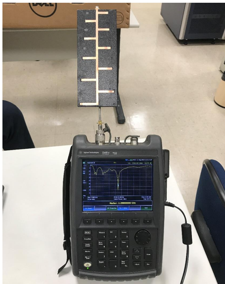
Figura 9: Setup para medição do parâmetro S11.
