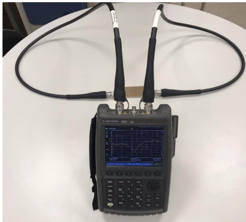
Figura 5: Setup para medição do parâmetro S21 das amostras.
