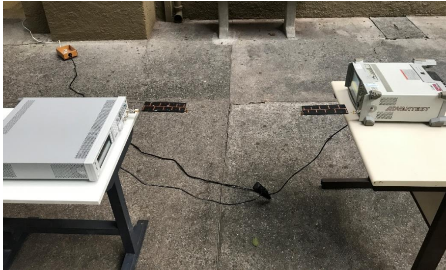
Figura 10: Setup em campo aberto para medição do ganho das antenas.
