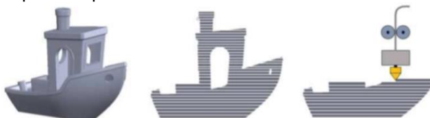
Figura 10 – Processo de Impressão por FDM.
