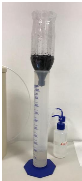
Figura 05 – Funil de Garrafa PET inserido em proveta
