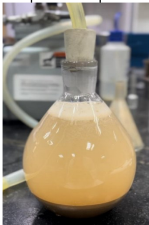
Fotografia 3. Ensaio de massa específica aparente no picnômetro.
