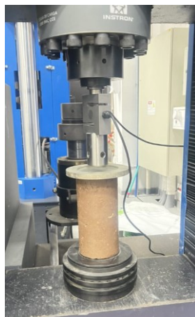
Fotografia 7. (a) corpo de prova de solo com reforço de 4% (b) corpo de prova de solo com reforço de 4% após a ruptura.
