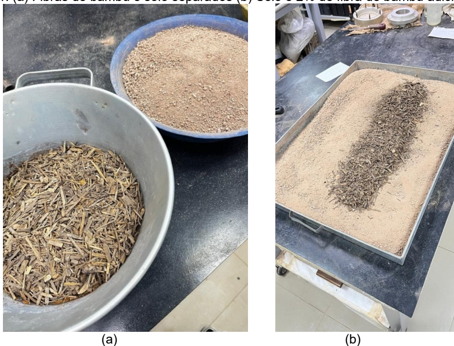
Fotografia 1. (a) Fibras de bambu e solo separados (b) Solo e 2% de fibra de bambu adicionadas.
