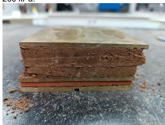
Fotografia 6. (a) corpo de prova de solo sem reforço após a ruptura no ensaio de cisalhamento direto com tensão normal de 100 kPa (b) corpo de prova de solo com reforço de 4% após a ruptura no ensaio de cisalhamento direto com tensão normal de 200 kPa.
