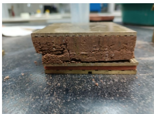
Fotografia 6. (a) corpo de prova de solo sem reforço após a ruptura no ensaio de cisalhamento direto com tensão normal de 100 kPa (b) corpo de prova de solo com reforço de 4% após a ruptura no ensaio de cisalhamento direto com tensão normal de 200 kPa.
