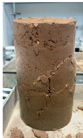
Fotografia 7. (a) corpo de prova de solo com reforço de 4% (b) corpo de prova de solo com reforço de 4% após a ruptura.
