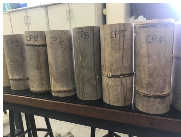
Figura 2. Corpos de Prova para Teste de Resistência à Compressão Bambu Phyllostachys Pubescens
