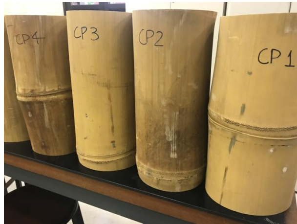
Figura 1. Corpos de Prova para Teste de Resistência à Compressão Bambu Dendrocalamus aesper
