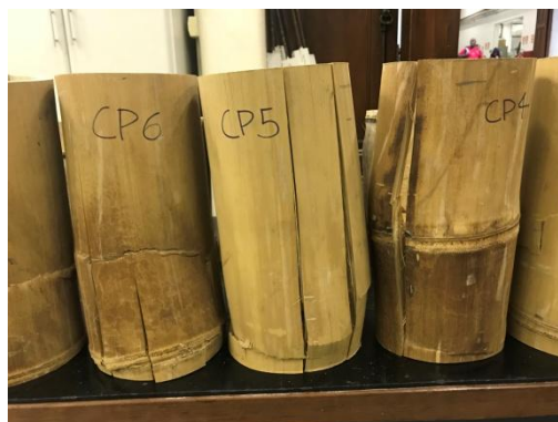
Figura 4. Corpos de prova rompidos da espécie Dendrocalamus aesper
