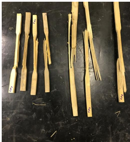
Figura 10. Corpos-de-prova de ambas as espécies rompidos
