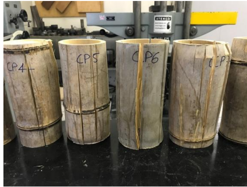
Figura 5. Corpos de prova rompidos da espécie Phyllostachys Pubescens
