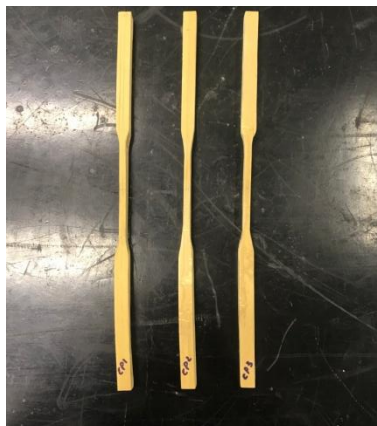
Figura 6. Corpos-de-prova para Ensaio de Tração Bambu Dendrocalamus aesper
