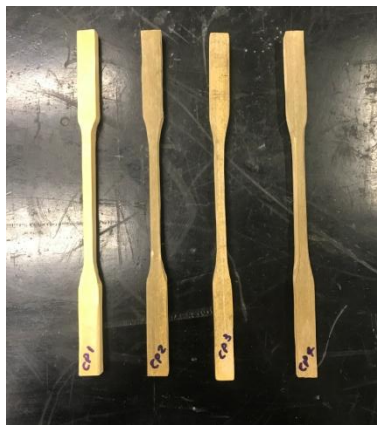
Figura 7. Corpos-de-prova para Ensaio de Tração - Bambu Phyllostachys Pubescens
