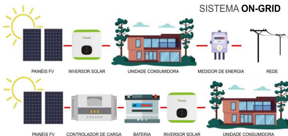
Figura 1 - Ilustração das etapas dos sistemas fotovoltaicos on-grid e off-grid
