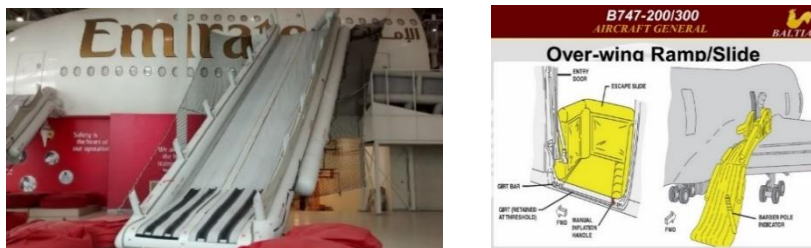
Figura 3. Escorregador de emergência e Esquema Escorregador de emergência
