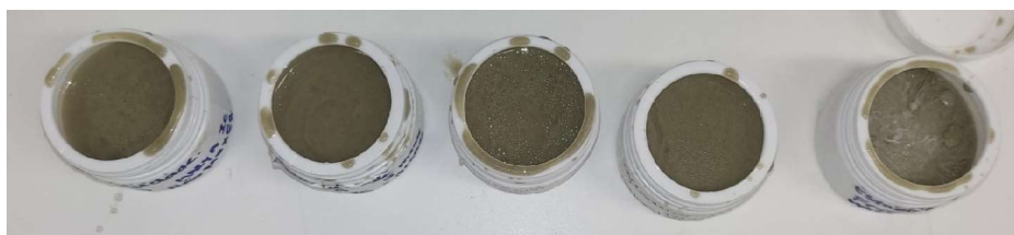
Fig 7. Separação de amostras de emulsão durante estudo de estabilidade.
