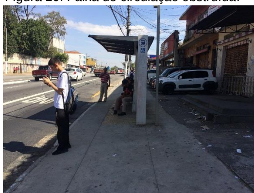
Figura 10. Faixa de circulação obstruída:
