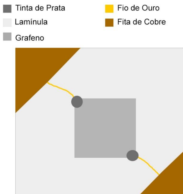
Fig. 3. Desenho esquemático do grafeno sobre lamínula com fios de ouro ligados a este através de tinta de prata. Os fios de ouro terminam em fitas de cobre que podem facilmente ser contactadas eletricamente.
