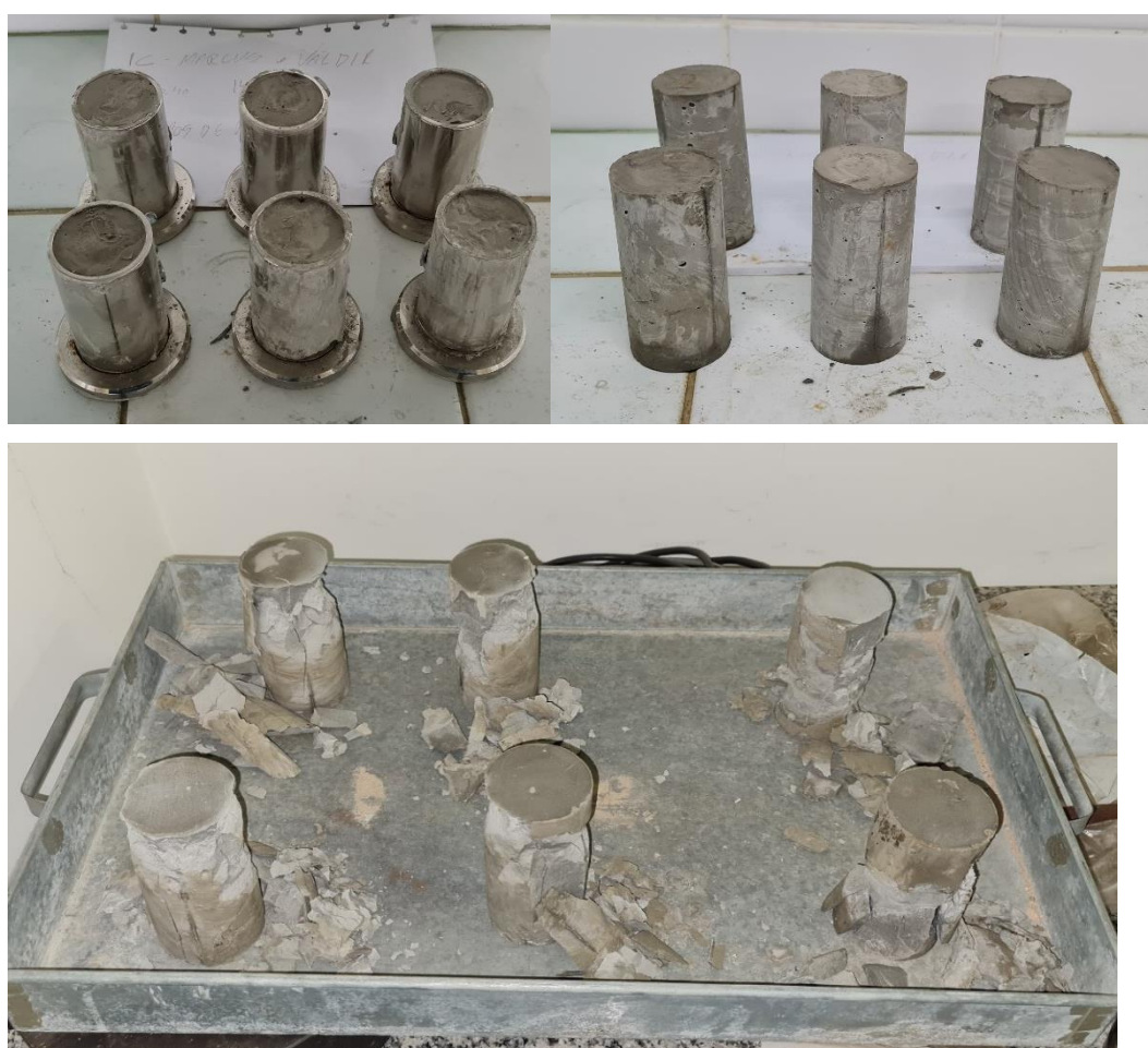
Figura 3.2 – Corpos de prova de pasta água cimento após a concretagem (a), corpos de prova fora dos moldes (b), corpos de prova rompidos (c).
