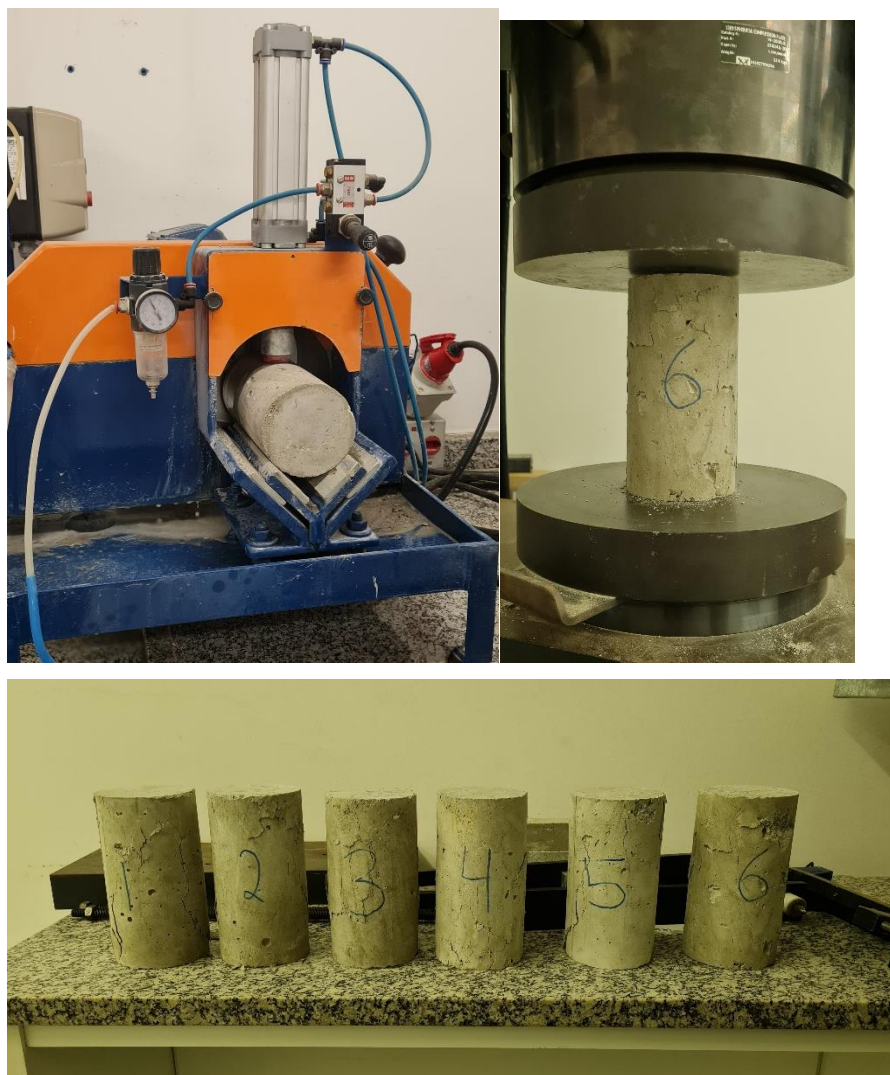
Figura 3.3 – CP na retífica (a), CP no ensaio de compressão (b), CPs após os ensaios (c). Fonte: Autor.
