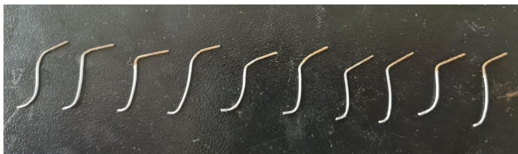
Figura 4.3 - Fibras de aço após o ensaio de arrancamento em modo II. Fonte: Autor.
