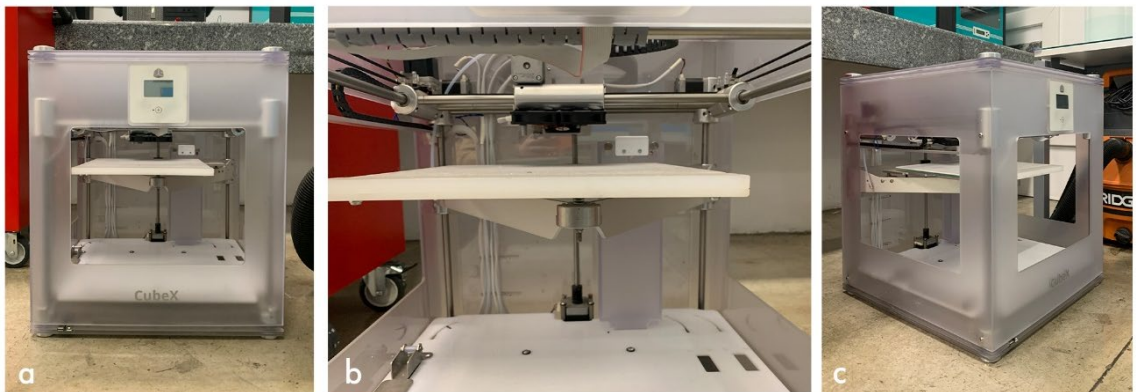
Figura 9 - Impressora CubeX 3D, imagem frontal (a), mesa de impressão (b) e isométrica (c). Fonte: Autora
