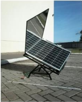
Figura 5 - Comparação entre placa fixa e placa com acoplamento de espelho.
