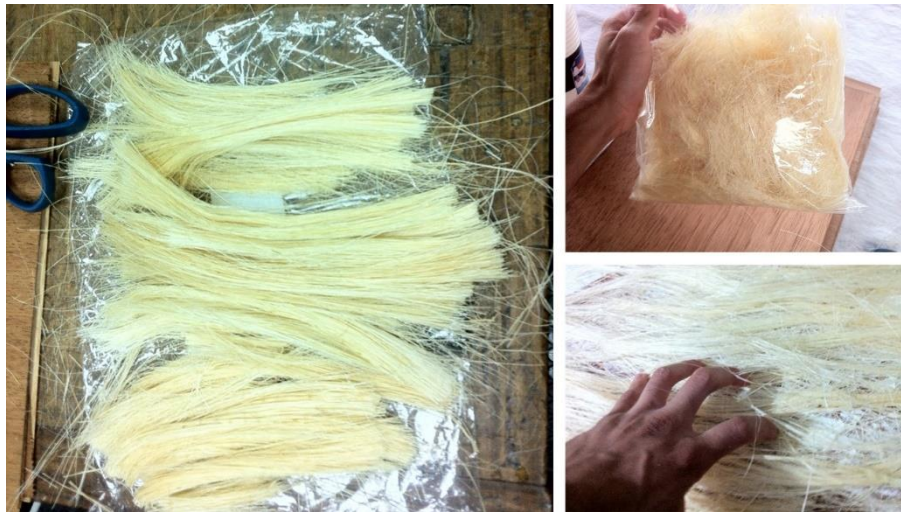
Figura 3. Chumaços de fios de Fibra de sisal e laminação.
