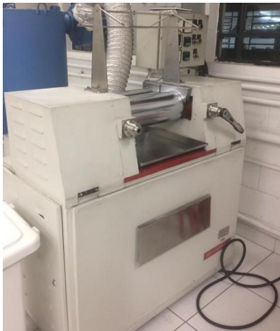
Figura 4 – Calandra do Laboratório de Caracterização e Processamento de Materiais da Universidade Presbiteriana Mackenzie, campus Higienópolis
