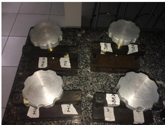
Figura 6 - Dispositivos utilizados para realização dos ensaios de deformação permanente à compressão (Compression set)
