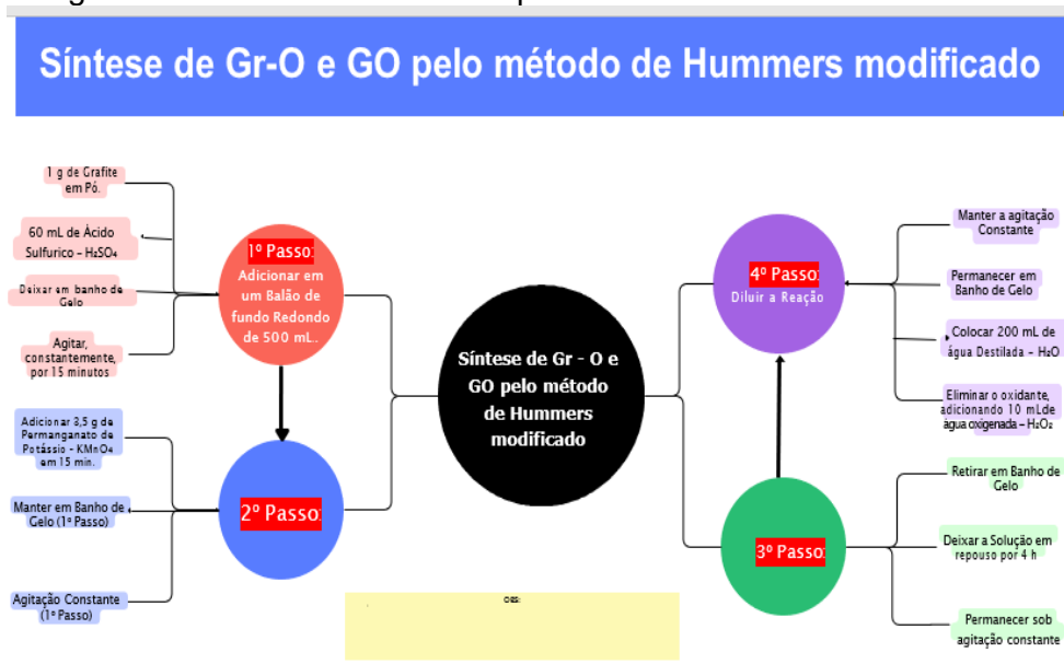
Figura 2 - Síntese de Gr-O e GO pelo método de Hummers modificado
