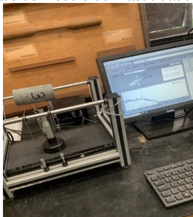
Fotografia 4 – Ensaio de módulo de Elasticidade dinâmico e estático
