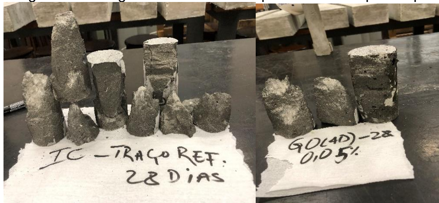
Fotografia 4 – Imagens do ensaio à compressão dos corpos de prova
