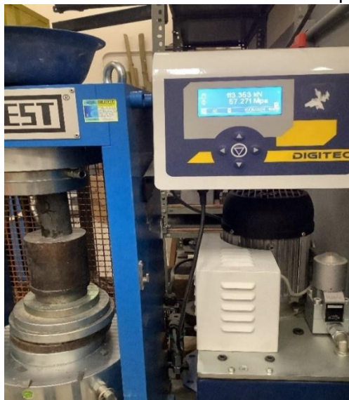
Fotografia 2 – Ensaio de resistência à compressão
