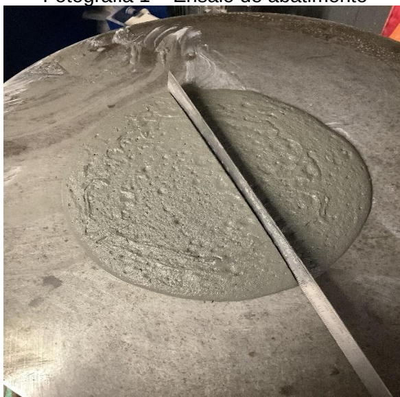
Fotografia 1 – Ensaio de abatimento
