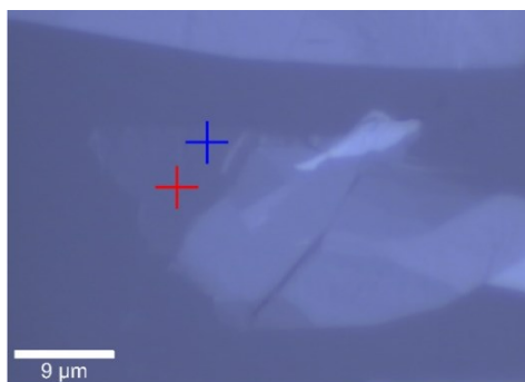
Figura 13. (a) Imagem por microscopia óptica do grafeno esfoliado (b) Espectros dos pontos indicados em a.
